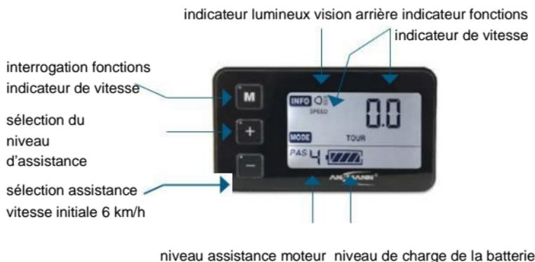
Lorsque vous mettez le système sous tension en allumant la batterie, le niveau d'assistance est automatiquement réglé au niveau 2. Appuyer sur les touches + et - vous permet de changer le niveau d'assistance du moteur de zéro (aucune assistance) ou de 1 au niveau maximum 6.
